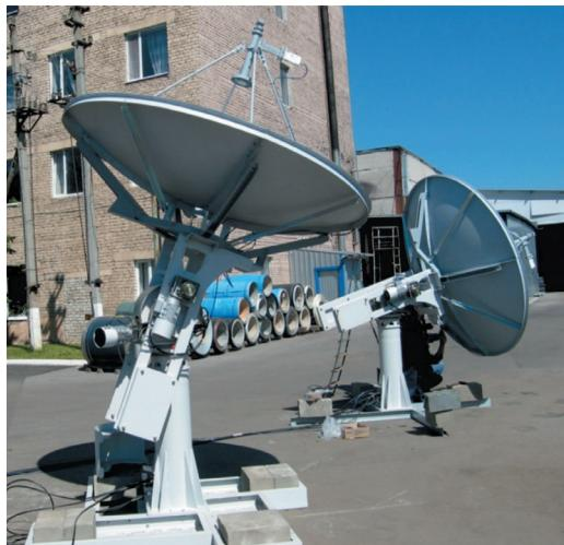
**Полноповоротная антенная система
